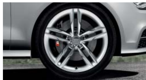
Jantes en aluminium coulé 5 branches étoile (S) 9 J x 20 avec pneus 265/35 R 20
