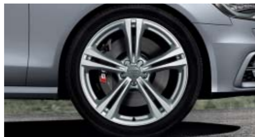
Jantes en aluminium coulé 5 branches étoile (S) 8,5 J x 20 avec pneus 255/35 R 20
