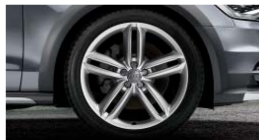
Jantes en aluminium coulé 5 branches doubles 8,5 J x 20 avec pneus 255/40 R 20
