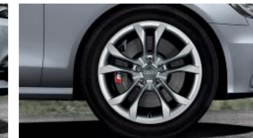
Jantes en aluminium coulé 5 branches parallèles (S) 8,5 J x 19 avec pneus 255/40 R 19
