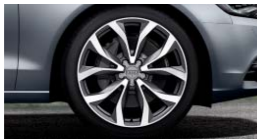
Jantes en aluminium forgé 5 branches en Y anthracite, partiellement polies, 8,5 J x 20 avec pneus 255/35 R 20
