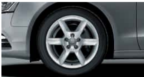
Jantes en aluminium coulé style 6 branches paraboliques 8 J x 17 avec pneus 245/45 R 17
