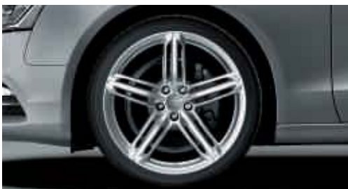
Jantes en aluminium coulé Audi exclusive style 5 branches triples 9 J x 19 avec pneus 255/35 R 19
