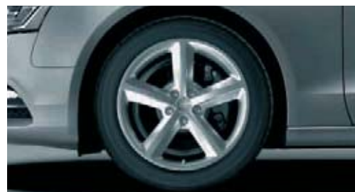
Jantes en aluminium coulé Audi exclusive style 5 branches en étoile 8,5 J x 18 avec pneus 245/40 R 18
