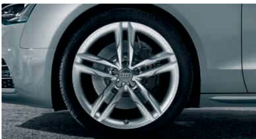
Jantes en aluminium coulé style 5 5 branches parallèles en étoile 8,5 J x 19 avec pneus 255/35 R 19
