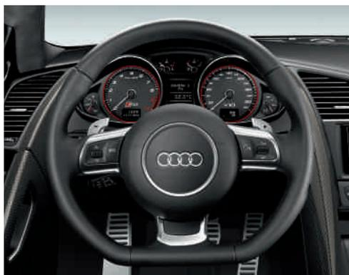
**Volant Sport multifonction en cuir style 3 branches** aplati en bas, avec airbag grand volume, réglable en hauteur et en profondeur, permet de commander les fonctions de base des autoradios Audi, de l'interface Bluetooth ou de la préparation pour téléphone portable ; avec palettes de changement de vitesses style aluminium avec boîte S tronic
