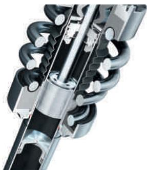
**Le point central de l'amortisseur** est un piston avec une bobine magnétique. L'huile des amortisseurs coule par le piston en étant influencée par un champ magnétique changeant. En augmentant la résistance du flux, la puissance des amortisseurs est également augmentée. Cela arrive lorsque les particules de fer contenues dans l'huile sont alignées le long des lignes du champ magnétique.
