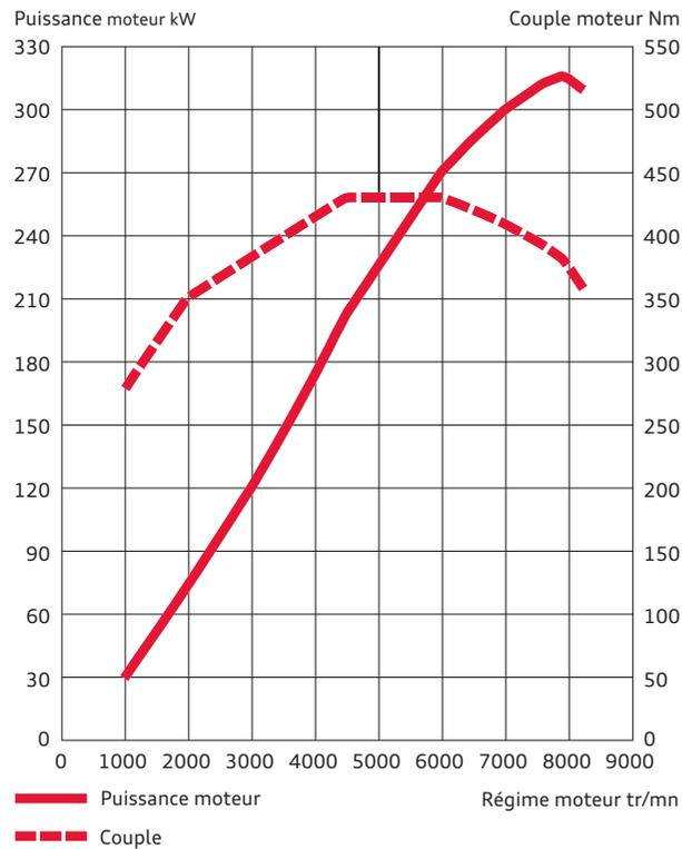
**Moteur V8 avec une cylindrée maximale de 4 163 cm<sup>3</sup>**
