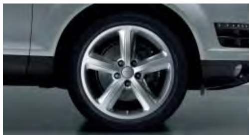
Jantes en aluminium coulé Audi exclusive style 5 branches 1 , 9 J x 20 avec pneus 275/45 R 20
