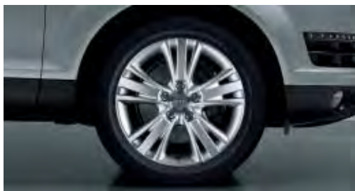
Jantes en aluminium coulé style 5 branches en V, 8,5 J x 19 avec pneus 265/50 R 19
