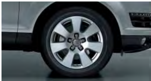
Jantes en aluminium forgé style 7 branches, 7,5 J x 18 avec pneus 235/60 R 18
