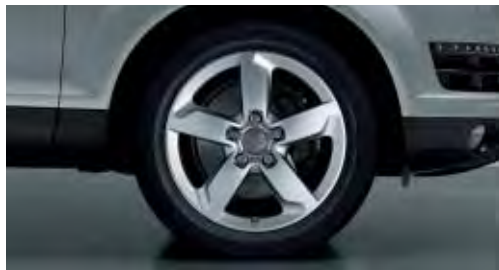
Jantes en aluminium coulé style 5 branches structurées, 8,5 J x 19 avec pneus 265/50 R 19
