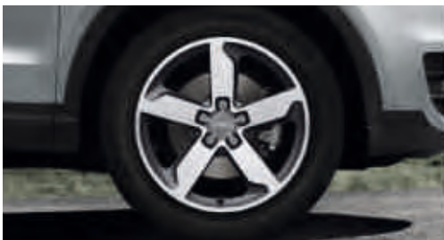
Jantes en aluminium coulé style 5 branches, partiellement polies, 7 J x 18 avec pneus 235/50 R 18
