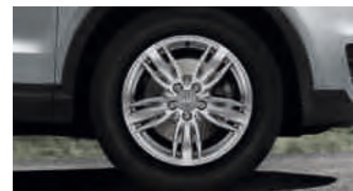
Jantes en aluminium coulé style 5 branches en triade, 7 J x 17 avec pneus 235/55 R 17
