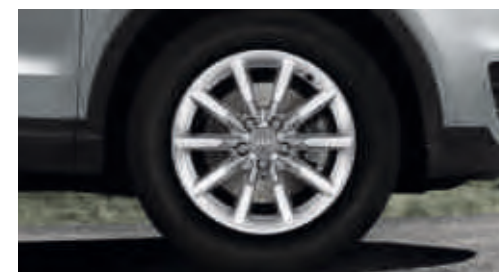
Jantes en aluminium coulé style 10 branches, 7 J x 17 avec pneus 235/55 R 17
