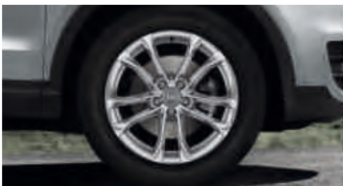
Jantes en aluminium coulé style 5 branches doubles, 7 J x 18 avec pneus 235/50 R 18
