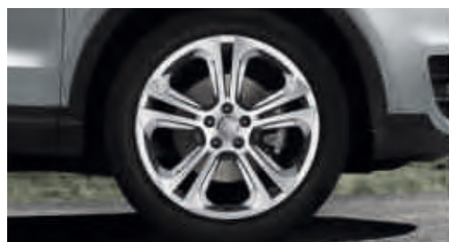
Jantes en aluminium coulé Audi exclusive style 5 branches doubles offroad* , 8,5 J x 19 avec pneus 255/40 R 19, incluant enjoliveurs de passage de roue plus larges
