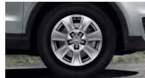
Jantes en aluminium forgé style 7 branches, 6,5 J x 16 avec pneus 215/65 R 16
