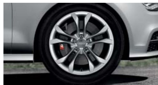
Jantes en aluminium coulé 5 branches doubles (S) 8,5 J x 19 avec pneus 255/40 R 19
