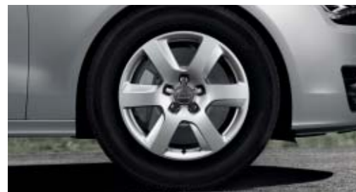
Jantes en aluminium forgé 6 branches 8 J x 17 avec pneus 235/55 R 17
