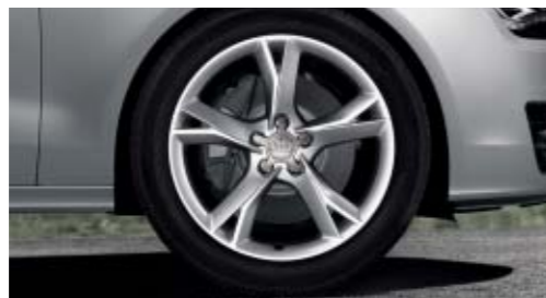
Jantes en aluminium coulé 5 branches en Y 8,5 J x 19 avec pneus 255/40 R 19
