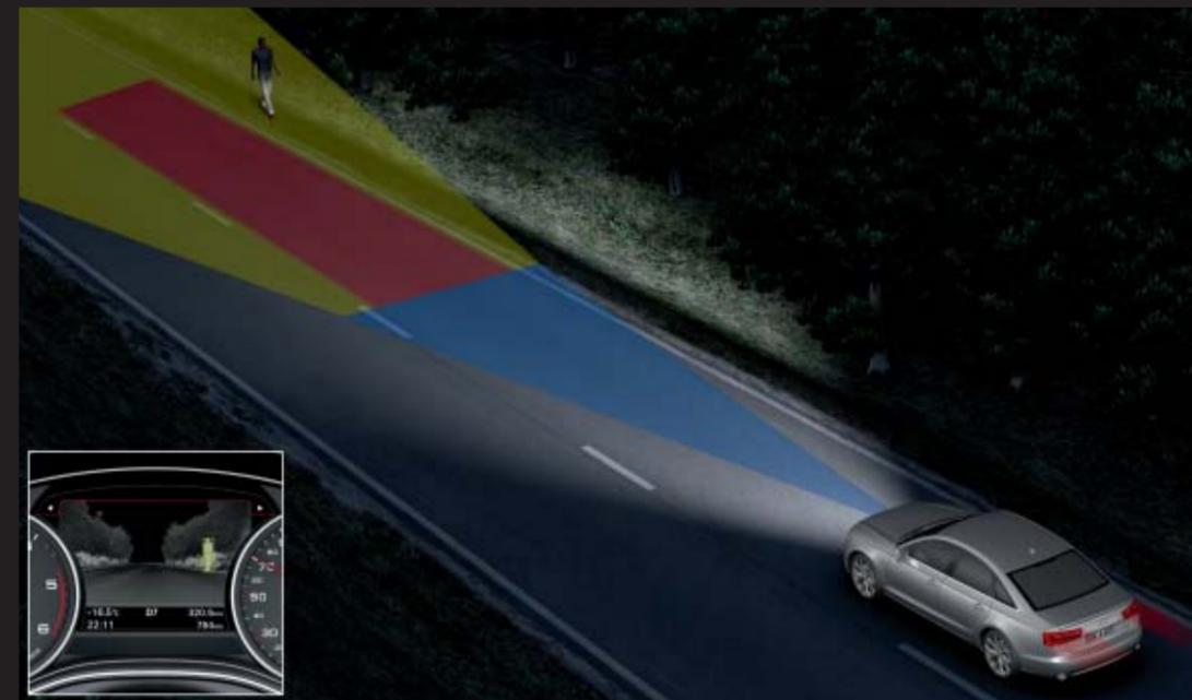
Si le système détecte un risque de collision, la couleur jaune du marquage passe au rouge et un signal sonore retentit. La personne est en outre éclairée brièvement 3 fois par le phare droit (marquage lumineux).
