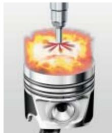
La **pré-injection** entraîne une combustion « douce » et donc une excellente acoustique de combustion, ainsi qu'un fonctionnement agréable du moteur.
