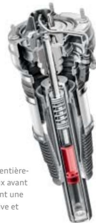
Les ressorts pneumatiques entièrement portants sur les essieux avant et arrière du véhicule assurent une sensation de conduite sportive et confortable.
