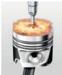
Les **piézo-injecteurs** s'ouvrent et se ferment en une fraction de millisecondes et injectent le carburant à plusieurs reprises dans la chambre de combustion à une pression pouvant aller jusqu'à 1 800 bars. Lors d'une injection, une dose infime, inférieure à un millième de gramme, de carburant est pulvérisée.
