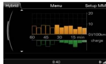
2 diagrammes à barres indiquent toutes les 5 minutes la consommation moyenne du moteur à combustion (en orange) et la quantité de récupération du moteur électrique (en vert).
