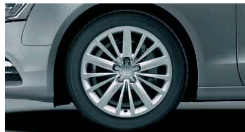
Jantes en aluminium coulé style 15 rayons en étoile 8,5 J x 18 avec pneus 245/40 R 18
