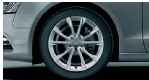
Jantes en aluminium coulé style 5 branches en V 8,5 J x 18 avec pneus 245/40 R 18
