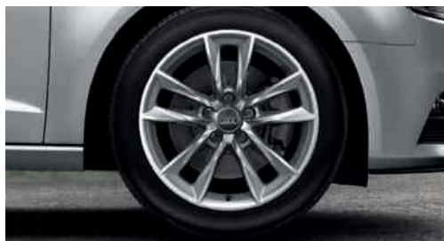
Jantes en aluminium coulé style 5 branches cinétiques 7,5 J x 17 avec pneus 225/45 R 17 (en option avec pneus avec propriétés de roue de secours)
