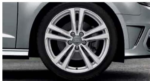
Jantes hiver en aluminium coulé style 5 branches parallèles (style 5) 7,5 J x 18 avec pneus 225/40 R 18, vitesse maximale autorisée 240 km/h, non compatibles chaînes-neige
