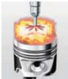
**La pré-injection** entraîne une combustion « douce » et donc une excellente acoustique de combustion, ainsi qu'un roulement agréable du moteur.
