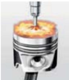
**Les piézo-injecteurs** s'ouvrent et se ferment en une fraction de milliseconde et injectent le carburant à plusieurs reprises dans la chambre de combustion à une pression pouvant aller jusqu'à 1 600 bars. Lors d'une injection, une dose infime, inférieure à un millième de gramme, de carburant est aspergée.
