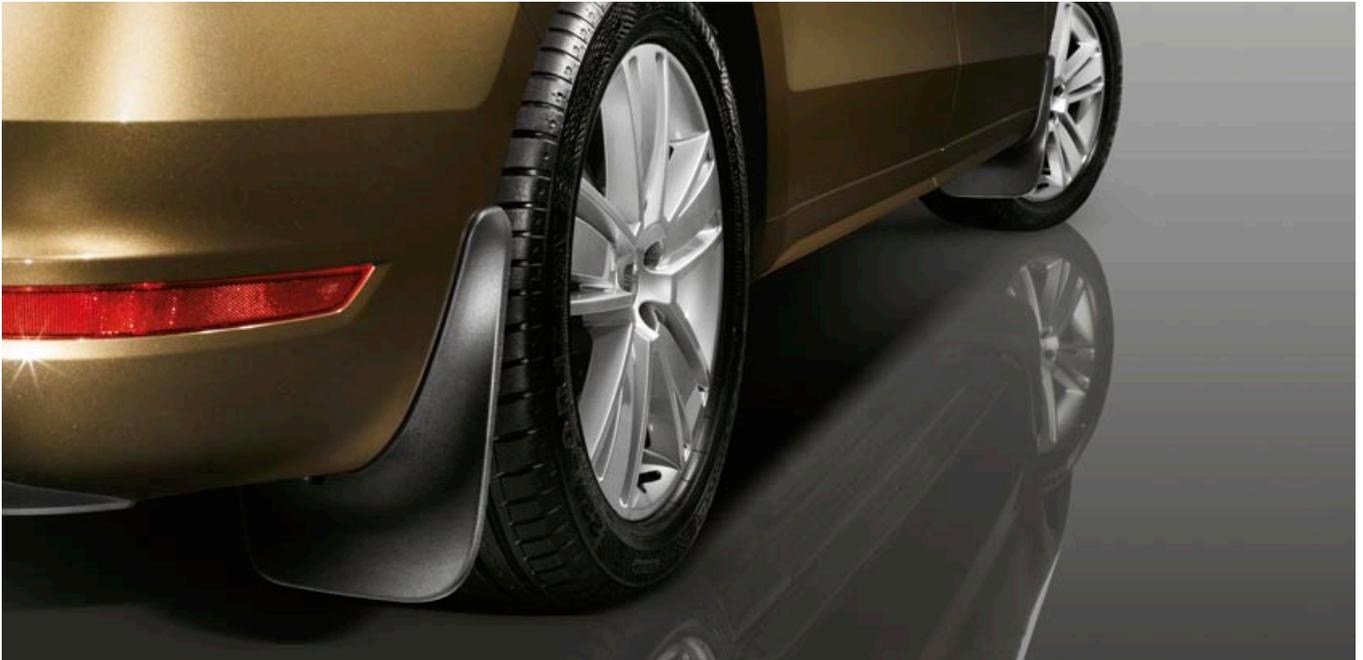
Les bavettes avant et arrière protègent le bas de caisse, les pare-chocs, les seuils latéraux, les portes et la partie arrière du véhicule contre les projections d'eau, de boue ou de graviers.
