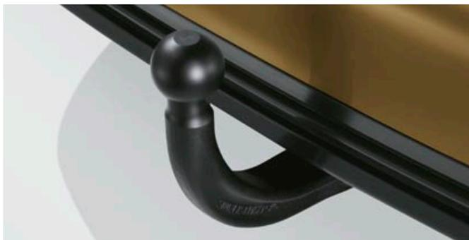
La rotule démontable sans outil permet de retirer le crochet d'attelage lorsque celui-ci n'est pas utilisé. Le faisceau 13 broches d'origine transmet les fonctions de l'ESP à votre attelage (pour les véhicules équipés de l'ESP).
